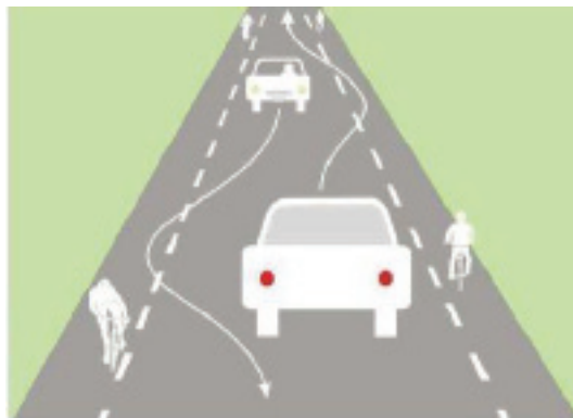
Chaussée à Voie Centrale Banalisée (CVCB).
